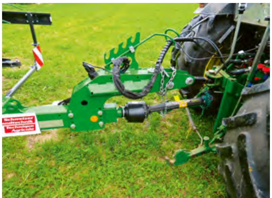
Die schlanke Deichsel mit vorbildlicher Schlauchgarderobe ermöglicht eine Untenanhängung.
