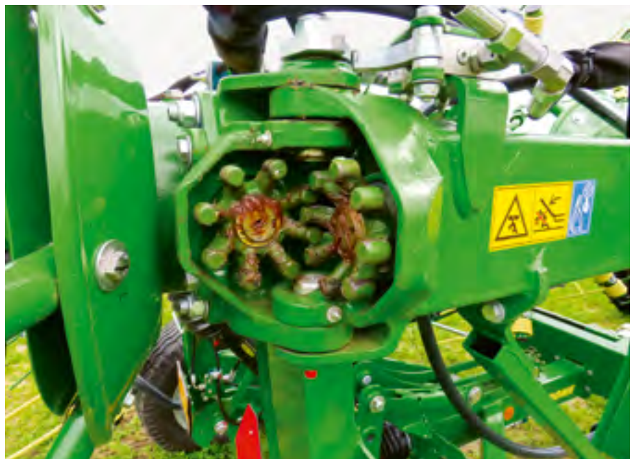
Wartungsarm und in jeder Position kraftschlüssig sind die «OctoLink»-Fingerkupplungen.
