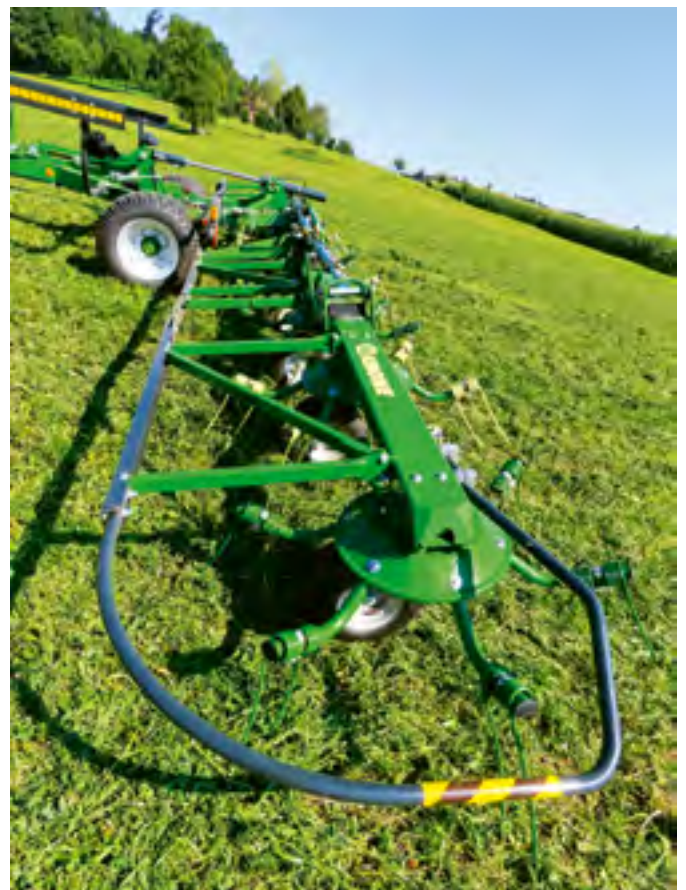
Die massiven Schutzbügel dienen gleichzeitig als Versteifung.
