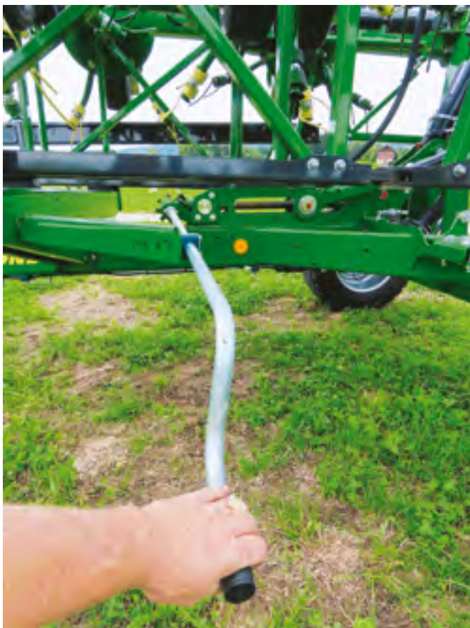
Über die seitliche Kurbel lässt sich die Arbeitshöhe einfach einstellen.
