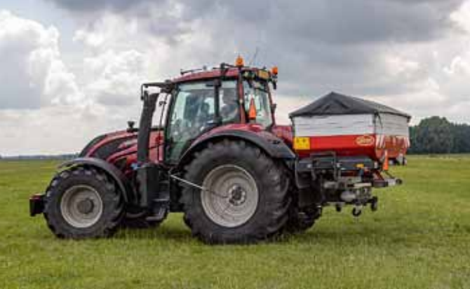
Der Valtra T174 Direct von Thijssen hat Michelin XeoBib-Reifen mit Reifendruckregelung für minimalen Bodendruck.
