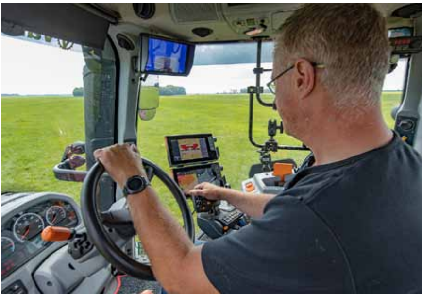
Ein zweiter SmartTouch-Bildschirm ermöglicht es Thijssen, die Daten des Traktors und des angeschlossenen Isobus-Geräts gleichzeitig zu sehen, ohne dass er den Bildschirm wechseln muss. Alle Daten und Einstellungen von Traktor und Gerät sind in Reichweite. Der Bildschirm oben stammt von einer Überwachungskamera.
