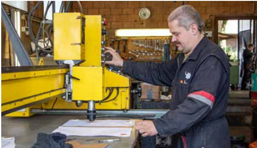
Rolf Schüpbach brennt ein Metallelement nach Zeichnung aus.
