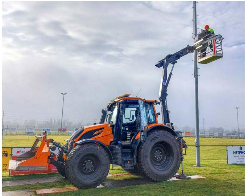
Der Heckkran mit Arbeitskorb ermöglicht sicheres Arbeiten bis auf sieben Meter Höhe.
