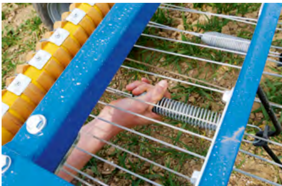
Die stark gespannten Federn sorgen bei jedem Zinken für einen gleichbleibenden Druck. Als Option für besonders frühe Kulturen gibt es ein spezielles Feder-in-Feder-System.
