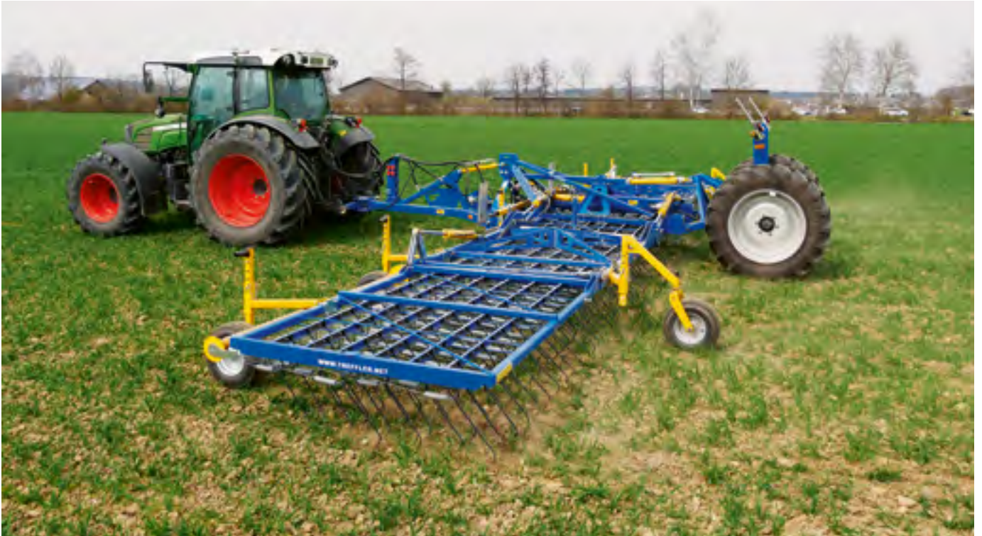
Der Treffler-Präzisions-Zinkenstriegel «TS 1220 M3» beim Einsatz in Seuzach ZH. Mit Fahrwerk wird der 12,2-Meter-Striegel an den Unterenkern angehängt. Bilder: Heinz Röthlisberger
