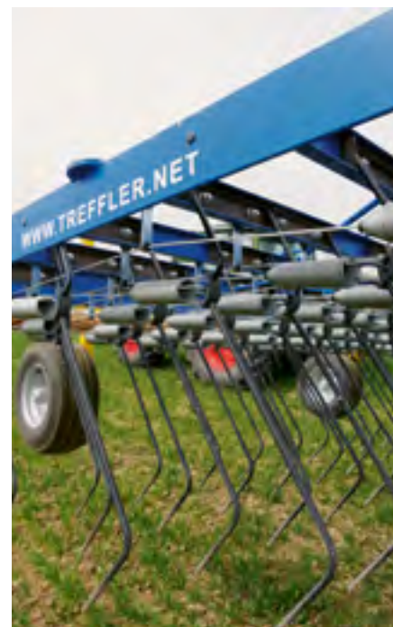
Der Druck der Zinken ist zentral hydraulisch von 100 g bis 5000 g auf 31 cm Federweg einstellbar. Die Federn werden über die gelbe Rolle vorgespannt (Bild links).
