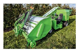
Reinigungs- und Transportsystem trennt das Mostobst perfekt von Gras und Laub. Die Abkipphöhe vom grossen Bunker ist variable und eignet sich für das Entleeren in Boxen, in grössere Erntewagen oder in Mostobstsortieranlagen. Alle Bedienelemente sind bequem vom Fahrersitz aus erreichbar und gewährleisten ein ganztägiges ermüdungsfreies Auflesen.
